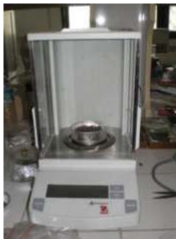
Gambar 5. Timbangan Analitik untuk Menentukan Berat Benih Lebih Teliti
