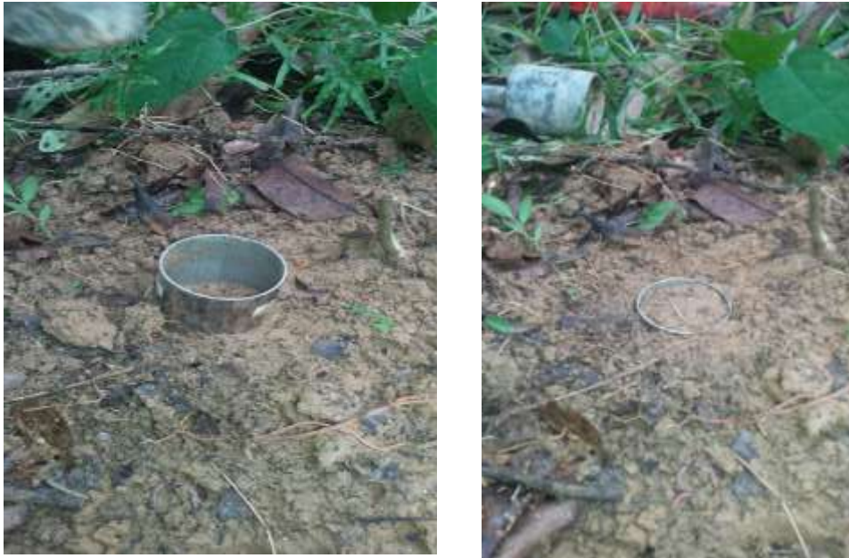
Gambar 3. Pengambilan Sample tanah utuh dengan ring sample
