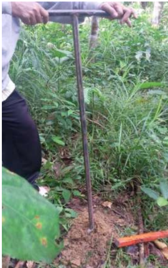
Gambar 2. Pengambilan Sample tanah dengan bor tanah
